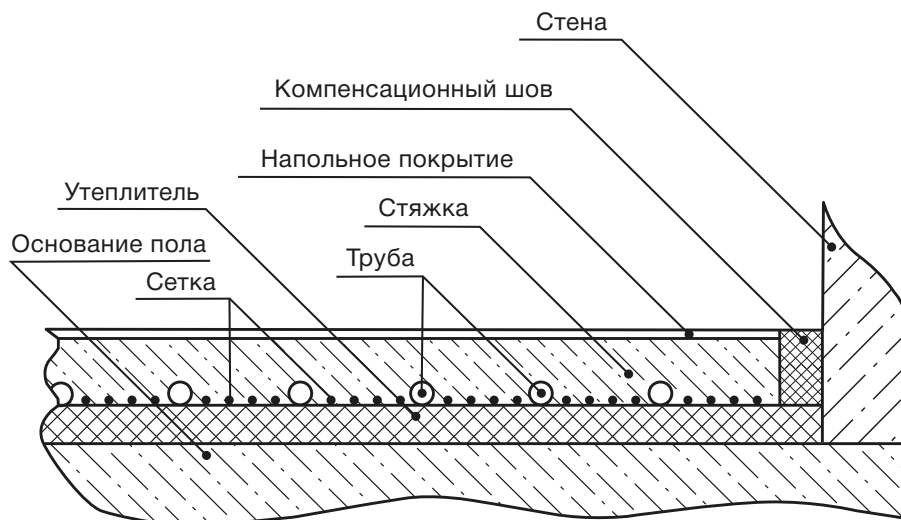
Рисунок 24. Схема устройства системы «Теплый пол»
